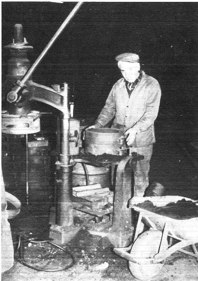
Fig. 14.— L'ouvrier confectionne un moulage. A gauche, machine pneumatique permettant de serrer le sable.
